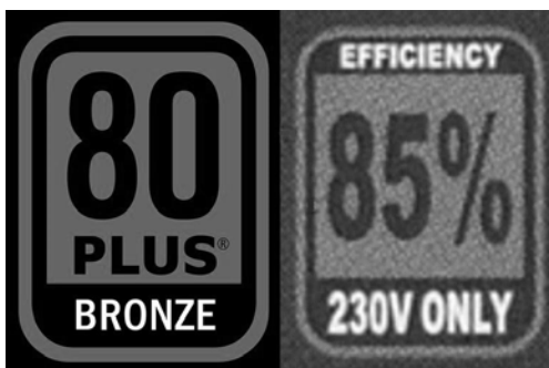
Рис. 4.27. Офіційний логотип 80 PLUS Bronze (ККД 88 %) та логотип невідомого виробника з нижчим ККД на рівні «білого» 80 PLUS (85 %).
