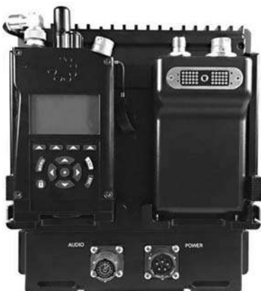
Рис. 4.19. Сучасна багатодіапазонна тактична радіостанція RF40V, здатна працювати в різних діапазонах та режимах для забезпечення стійкого зв'язку.
