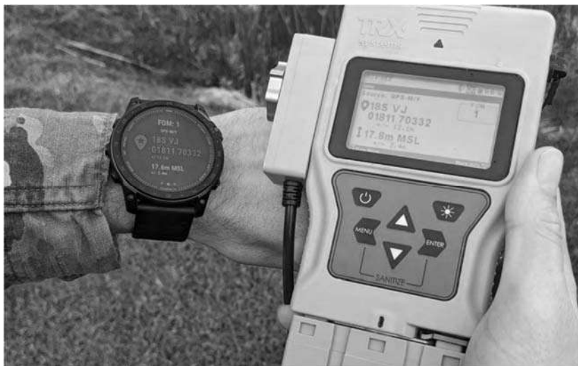
Рис. 4.22. Військовий портативний приймач супутникової навігації DAPS GEN II, інтегрований з тактичною системою управління.
