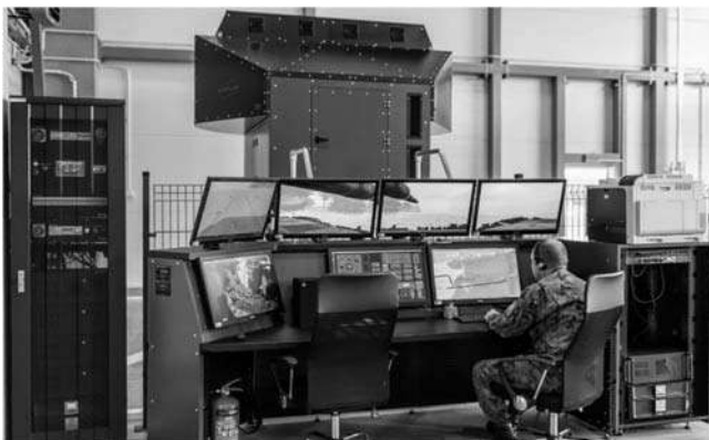
Рис. 4.41. Апаратно-програмний комплекс компанії Motion Systems, що реалізує симулятор управління танком Leopard.
