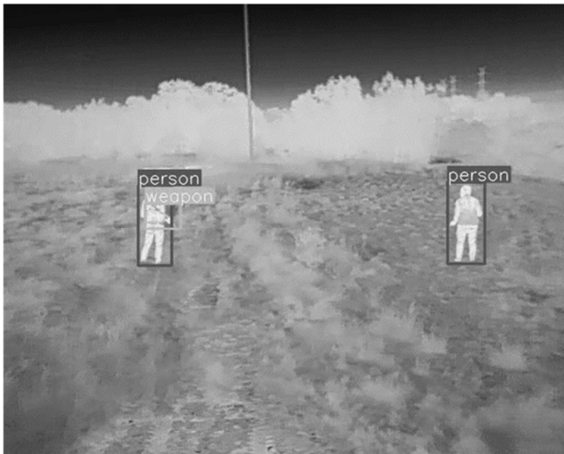
Рис. 4.24. Приклад роботи алгоритму машинного зору: розпізнавання людей та зброї з БПЛА в умовах нічної зйомки за допомогою тепловізійної камери.
