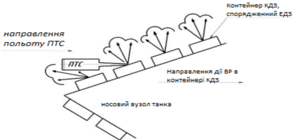
Рис. 2. Принцип дії вбудованого динамічного захисту
