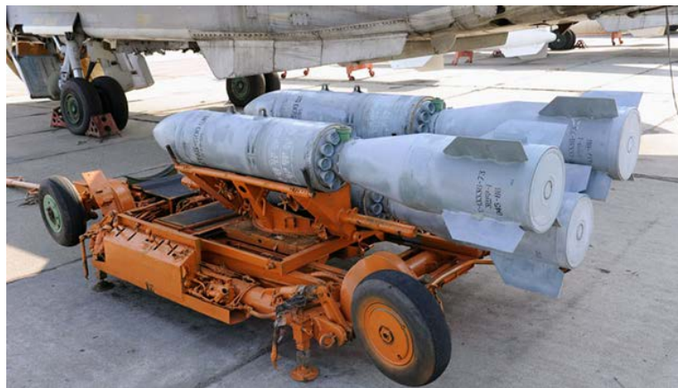
Рис. 3. Бетонобійна бомба ВКС РФ
