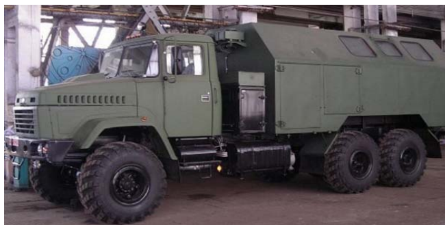
Рис. 11 – Станція ремонтно-зарядні акумуляторна
