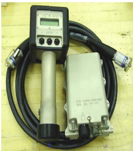
Рис. 7 – Обладнання для налаштування установок підричника та синхронізації з системою управління вогнем
