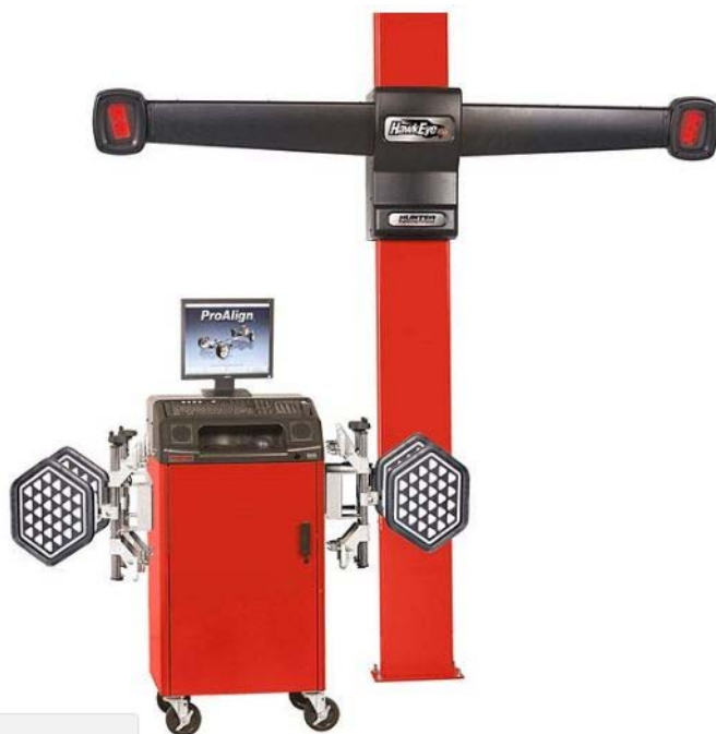
Рис. 7 – Стенд перевірки кутів установки коліс автомобіля з використанням 3D технології.
