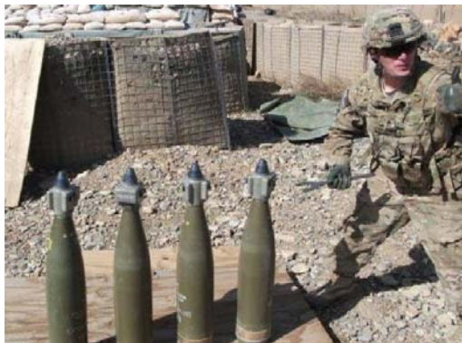
Рис. 1 – Комплект точного наведення снаряду XM1156 PGK (США)
