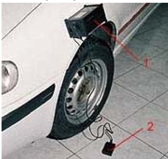
Рис. 4 – Ультразвуковий датчик для діагностування амортизаторів автомобіля.
