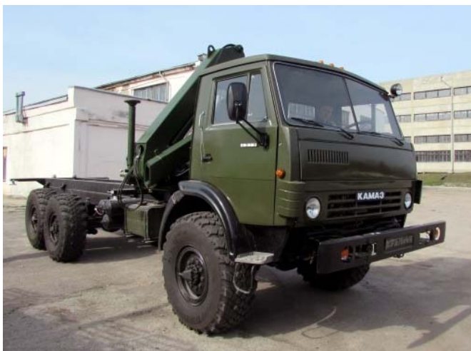
Рис 4 – Контейнеровоз з краном – маніпулятором
