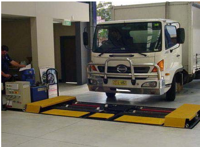
Рис. 2 – Випробувальний стенд EPS 625 для перевірки ПНВТ.
