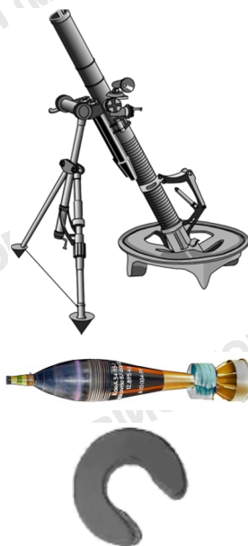
Рис. 1.23. Типовий міномет, міна з пороховими кільцями та окреме порохове кільце
