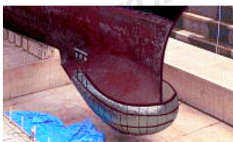
Рис. 4.47. Сонар SQS-53 (3 кГц) у бульбовому обтікачі крейсера CG-67
