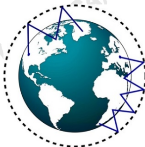
Рис. 4.42. Дальній радіозв'язок за допомогою просторових хвиль
