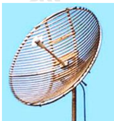
Рис. 4.37. Параболічні антени високої спрямованості та характерна діаграма спрямованості таких антен
