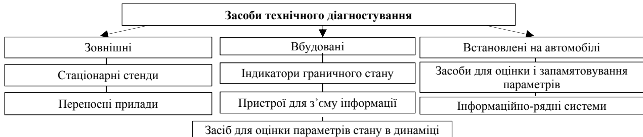
Рис. 1. Класифікація засобів технічного діагностування
